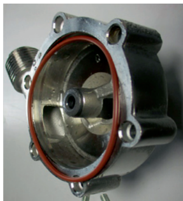
Abb. 1: Laufrad und Gehäuse der untersuchten Radialpumpe
