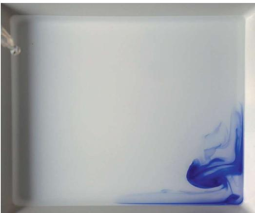
**Abb. 6:** Rückstrom von Wasser und Tinte zur Gefäßmitte, die Tinte ist jetzt nicht mehr an der Wasseroberfläche
