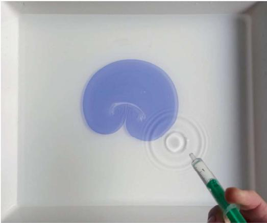
**Abb. 8:** Ein Tropfen einer Mischung von einem kleinen Tropfen Tensid in 50ml Wasser ist gerade neben eine gespreitete Tintenschicht eingefallen. Die sich ausbreitenden Oberflächenwellen sind bereits zu sehen.
