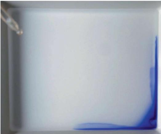
**Abb. 5:** Die von der Oberfläche verdrängte Tinte strömt in schneller Bewegung an die Gefäßwand und sinkt zugleich ab
