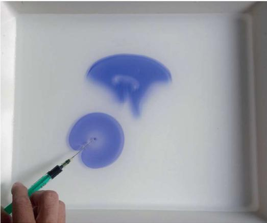
*Abb. 11: Auf der Wasseroberfläche lässt sich weiterhin Tinte spreiten, doch nicht mehr so leicht wie vor der Zugabe des verdünnten Tensids, und das Blau der entstehenden Tintenschicht ist dunkler*
