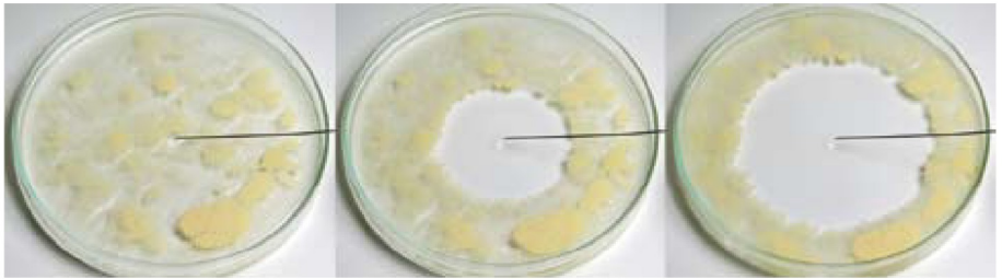
Abb. 9: Auf einer Wasserschicht befinden sich Lycopodium sporen. Mit einer Kanüle wird ein Tropfen tensidhaltiges Wasser auf die Wasserschicht gebracht. Das Tensid breitet sich schlagartig auf der Wasseroberfläche aus und verdrängt die Sporen.
