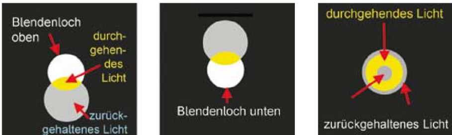
Abb. 12: Schlierenblenden asymmetrisch angeordnet. Links: oben. Mitte: unten und rechts: konzentrisch. Siehe auch Abb. 13
