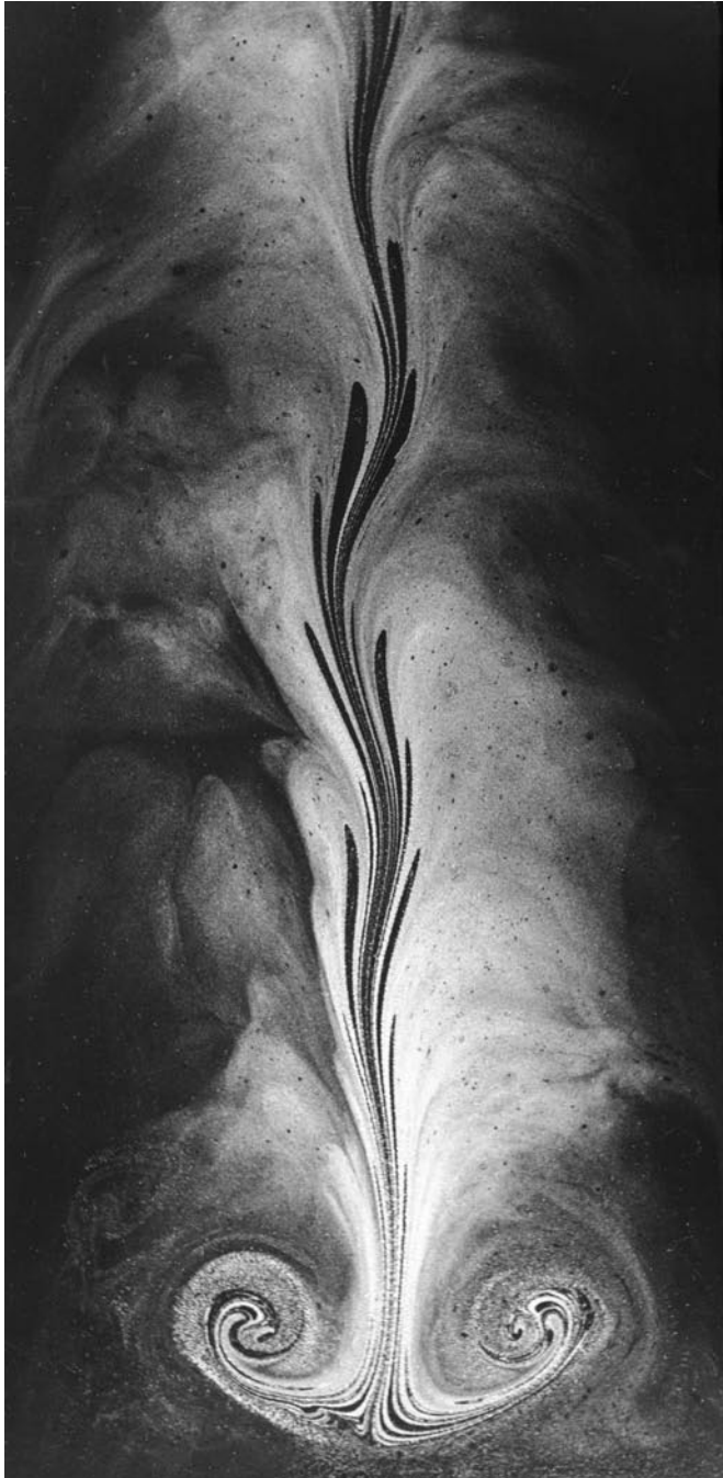
Abb. 16: Keimartige und voll entwickelte Karman- sche Wirbelstraße, Nachlaufformen hinter einem durch eine zähe Flüssigkeit gezogenen Stab; links hohe Zähigkeit, rechts etwas zäher als Wasser 6
